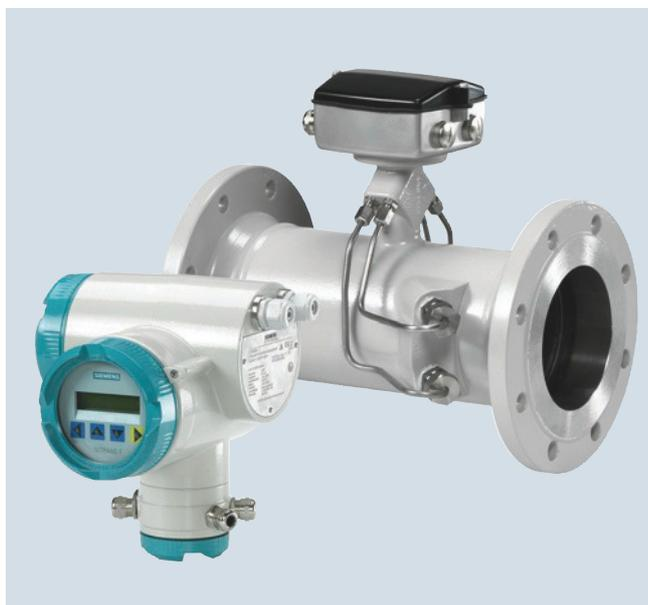
Die Gerätekombination aus Messaufnehmer SONO 3300 und Messumformer FUS060 ist ideal für Anwendungen in der allgemeinen Industrie. Messungen können unabhängig von Temperatur, Dichte, Druck und Leitfähigkeit der Flüssigkeit durchgeführt werden. Die Schallwandler sind nicht austauschbar.
