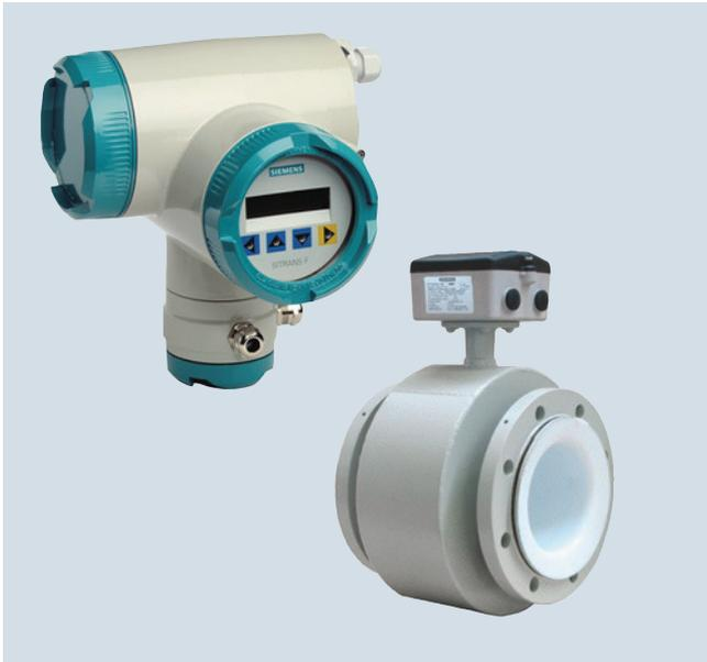
Der SITRANS F M TRANSMAG 2 mit dem Messaufnehmer SITRANS F M 911/E ist ein magnetisch-induktives Durchflussmessgerät mit getaktetem Wechselfeld, dessen Magnetfeldstärke sehr viel größer ist als beim konventionellen magnetisch-induktiven Durchflussmessgerät mit getaktetem Gleichfeld.
